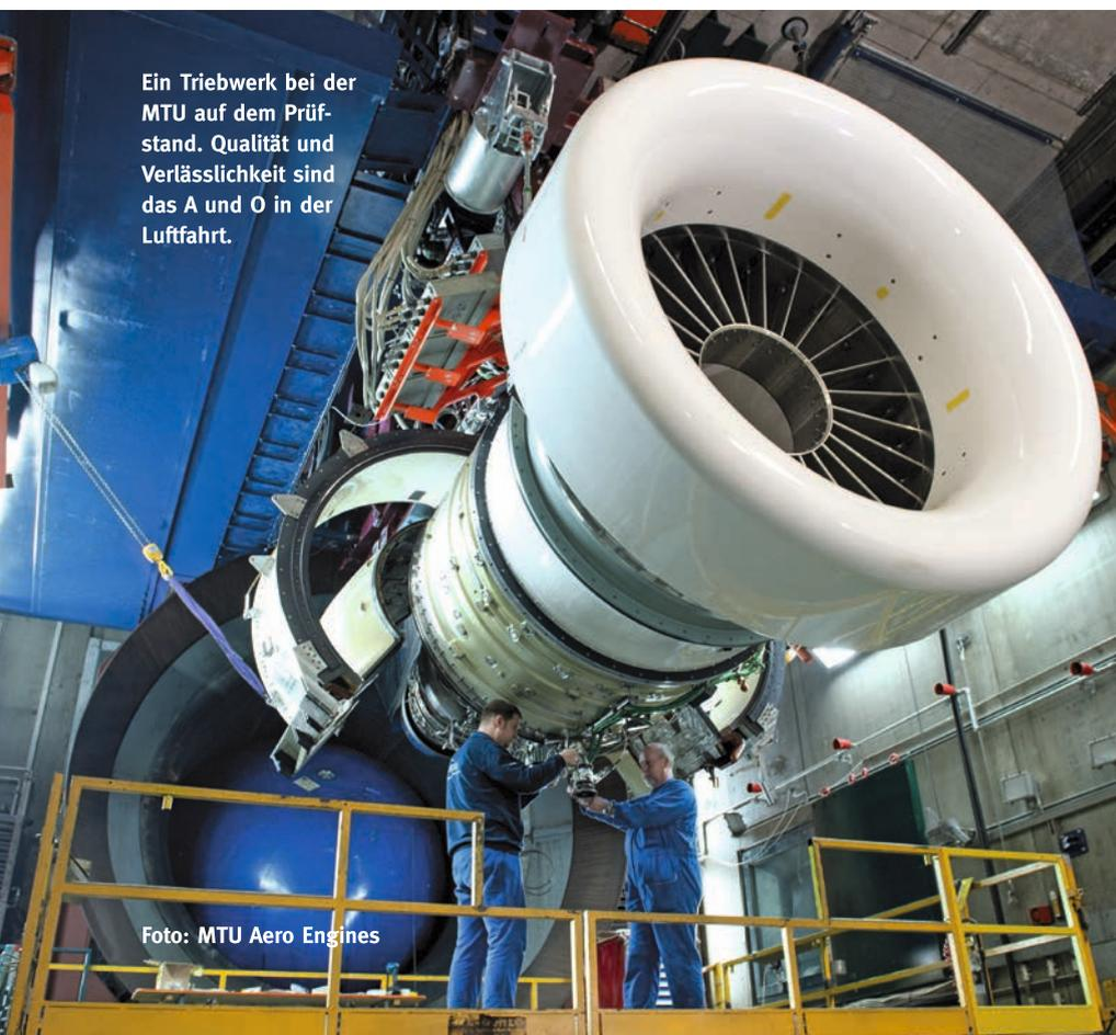
Ein Triebwerk bei der MTU auf dem Prüfstand. Qualität und Verlässlichkeit sind das A und O in der Luftfahrt.
