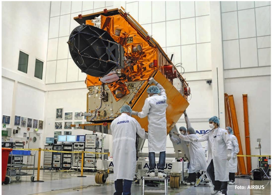
Airbus Ingenieure beim Testen des Ocean Satellite Sentinel-6A's in Ottobrunn
