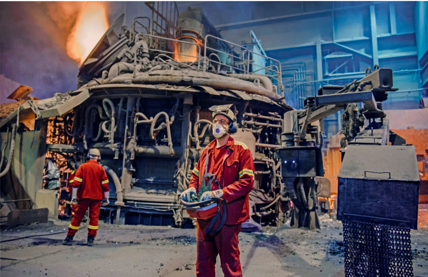
Befüllen, einschmelzen, abstechen: Der Dreiklang des Elektrolichtbogenofens wird durch hohe Strompreise gestört.
