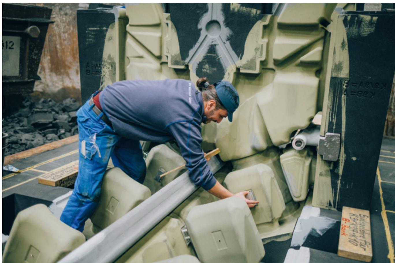
30 Tonnen wird der Guss wiegen, wenn er fertig ist. Das Gussteil wird später ein Dieselmotor für Kreuzfahrtschiffe.
