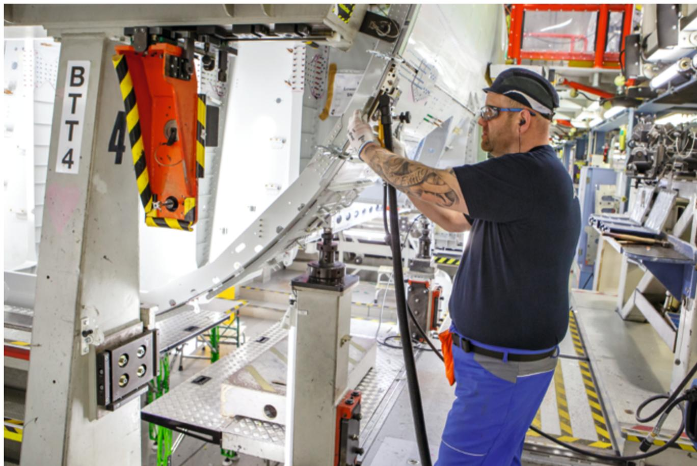
*Mit ruhiger Hand: Jan Ruschmeyer arbeitet in der Strukturmontage bei Airbus am Standort Hamburg. Bohrungen am Rumpfeines Flugzeugs müssen mit größter Präzision ausgeführt werden.*
