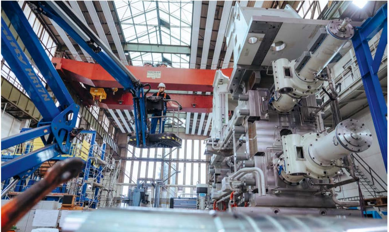
*Stauer heißt dieser Teil der Walzanlage. Er sorgt dafür, dass das Stahlband in der Form bleibt. Dafür, dass die Transformation in Schwung kommt, sorgt die IG Metall.*
