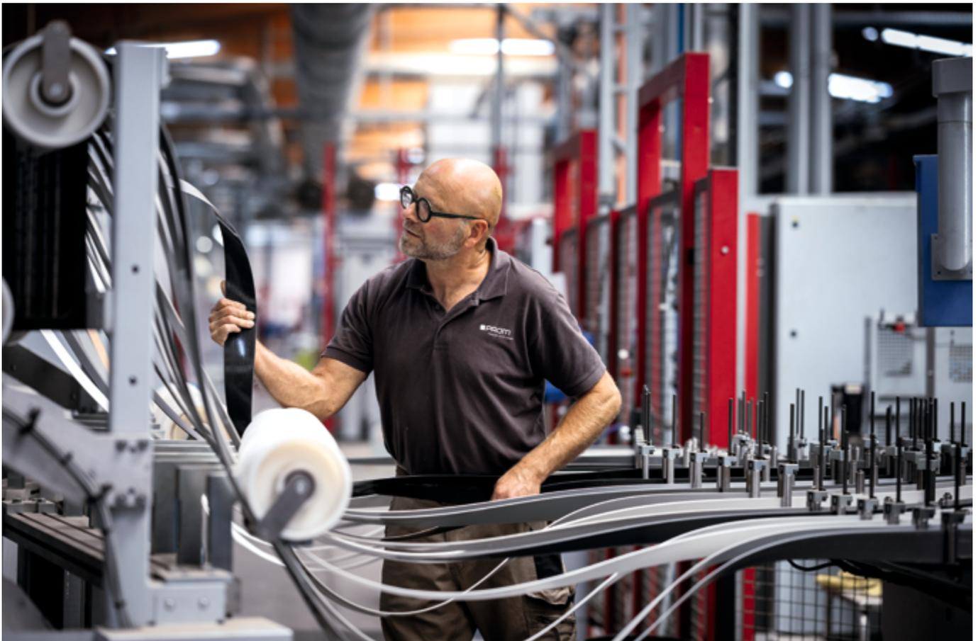
*Innovativ: Maschinenführer Ingolf Röder überwacht eine Anlage, die die Kanten der Türen mit einer neuartigen Funktionsbeschichtung versieht – ganz ohne Fugen. Mit dieser »Premiumkante« werden die Türen robuster oder gar stoßfest, bewirbt Prüm-Türenwerk sein Produkt. Auf dem Türenmarkt waren sie die Ersten, die die neue Kantentechnik eingeführt haben.*
