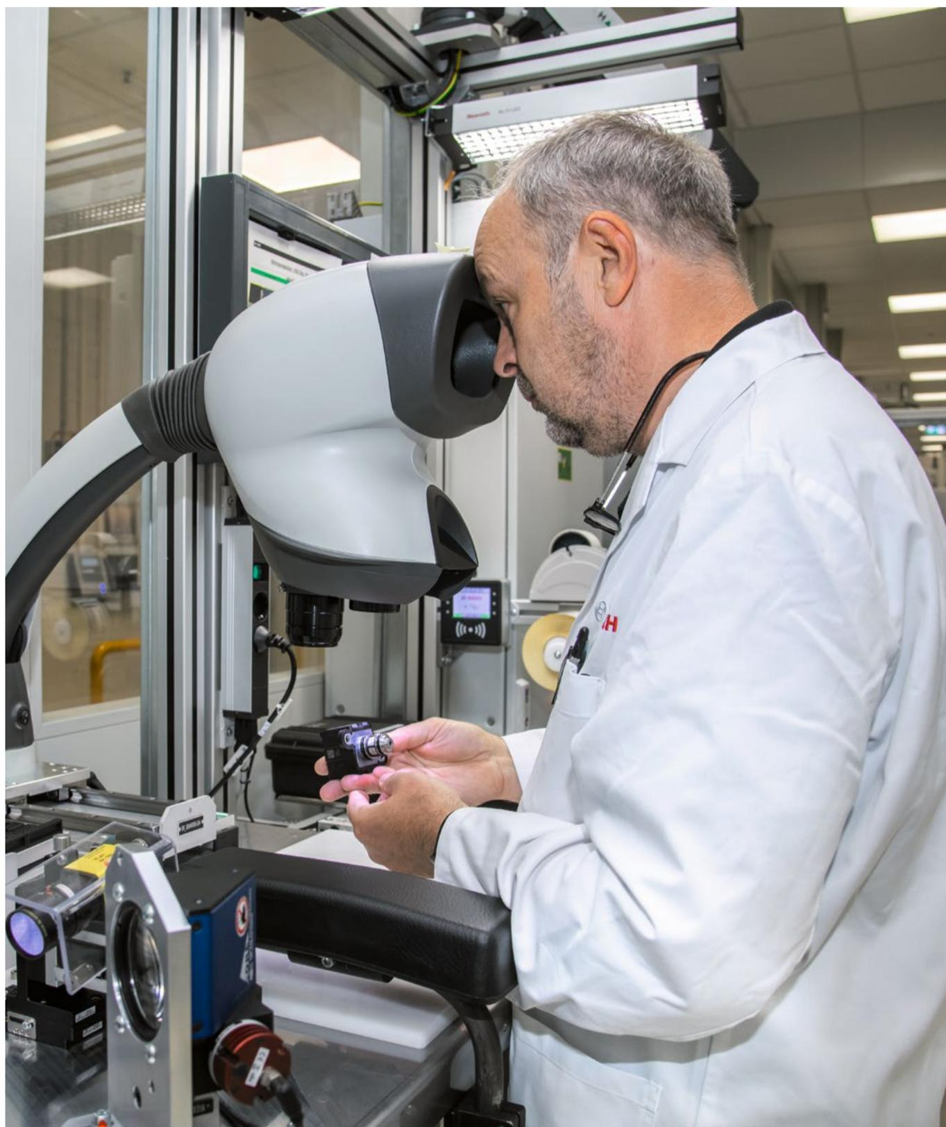
*Zukunftsprodukt Brennstoffzelle: Bei Bosch in Homburg fertigen die Beschäftigten mobile Brennstoffzellen für Nutzfahrzeuge (Foto: Hydrogen-Gasinjektor). Daneben produziert Bosch in Homburg auch stationäre Brennstoffzellen, etwa für die Industrie.*
