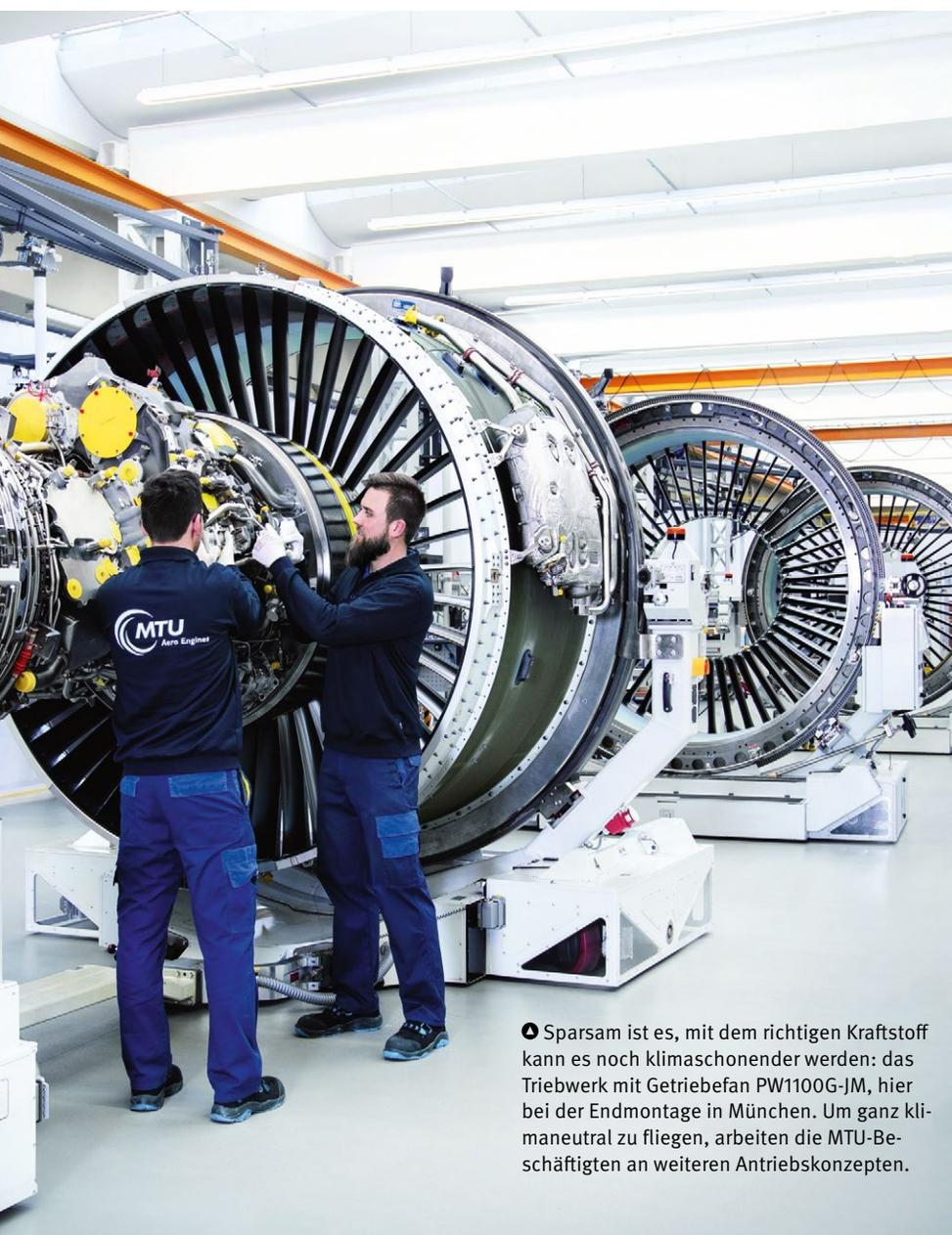
♣ Sparsam ist es, mit dem richtigen Kraftstoff kann es noch klimaschonender werden: das Triebwerk mit Getriebefan PW1100G-JM, hier bei der Endmontage in München. Um ganz klimaneutral zu fliegen, arbeiten die MTU-Beschäftigten an weiteren Antriebskonzepten.
