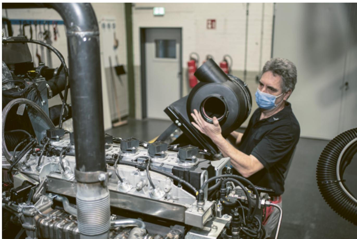
*Aktuell auf dem Prüfstand und ab 2024 in Serienproduktion: der Wasserstoffmotor von Deutz. Foto: Stephen Petrat*
