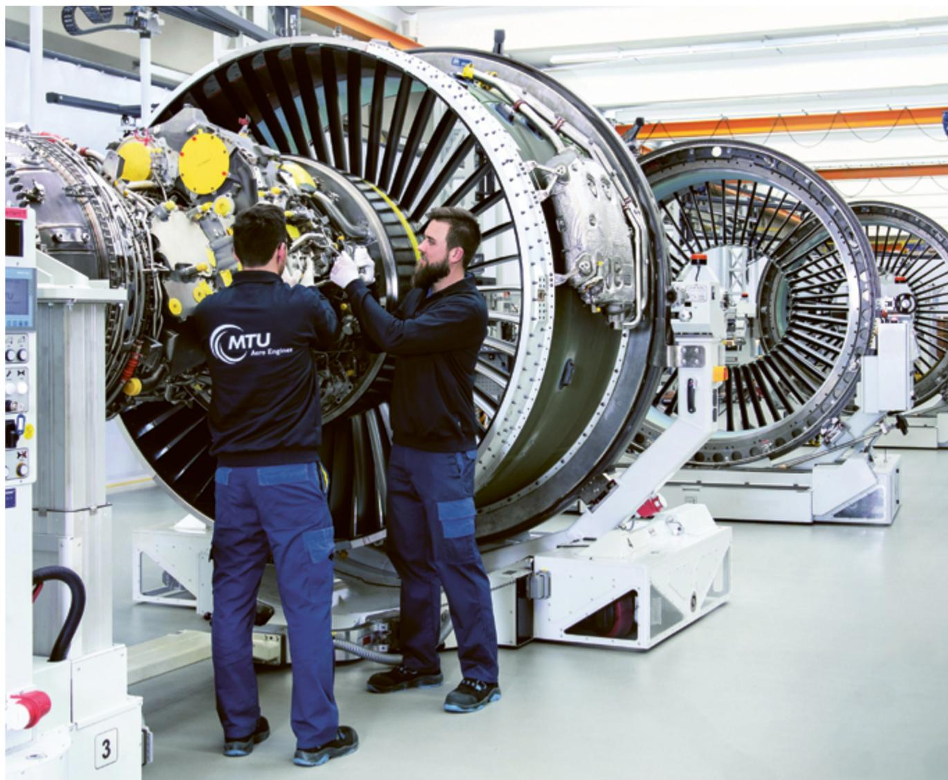
*Sparsam ist es, mit dem richtigen Kraftstoff kann es noch klimaschonender werden: das Triebwerk mit Getriebefan PW1100G-JM, hier bei der Endmontage in München. Um ganz klimaneutral zu fliegen, arbeiten die MTU-Beschäftigten an weiteren Antriebskonzepten. Foto: MTU Aero Engines AG*
