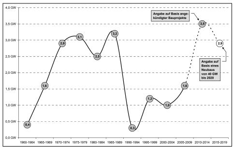
Abb. 5: Jährliche Inbetriebnahme von Großkraftwerkskapazitäten in Deutschland in Fünfjahresdurchschnitten (eigene Recherche und Berechnung auf Basis von Angaben unterschiedlicher Kraftwerksbetreiber)
