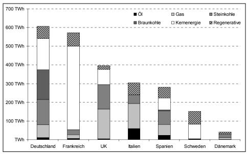
Abb. 23: Primärenergiemix der Bruttostromerzeugung in den fünf größten EU-Staaten bezogen auf die Stromerzeugung sowie zwei Staaten mit einem hohen Anteil regenerativer Stromerzeugung im Jahr 2004 (eigene Darstellung nach Zahlen aus Eurostat 2006)
