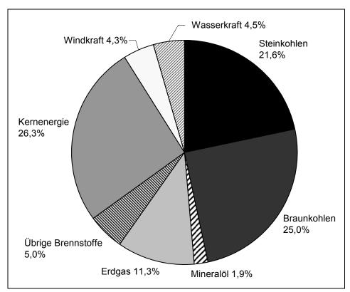
Abb. 9: Anteile der Energieträger an der Bruttostromerzeugung in Deutschland im Jahr 2005 (eigene Darstellung nach Zahlen aus Wittke / Ziesing 2006: 128)
