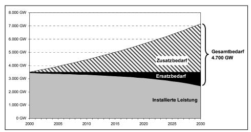
Abb. 22: Geschätzter Bedarf an neuen Stromerzeugungsanlagen durch Ersatz bestehender und Neubau zusätzlich erforderlicher Kapazitäten (Abbildung nach Zahlen aus IEA 2003 und eigenen Abschätzungen)
