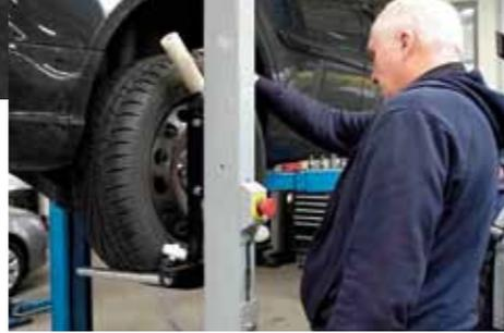
Eine Hebehilfe verhindert Belastungen beim Reifenwechsel in einer Kfz-Werkstatt.
