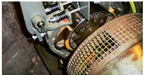
*Bremsblock einer Aufzugsanlage*
