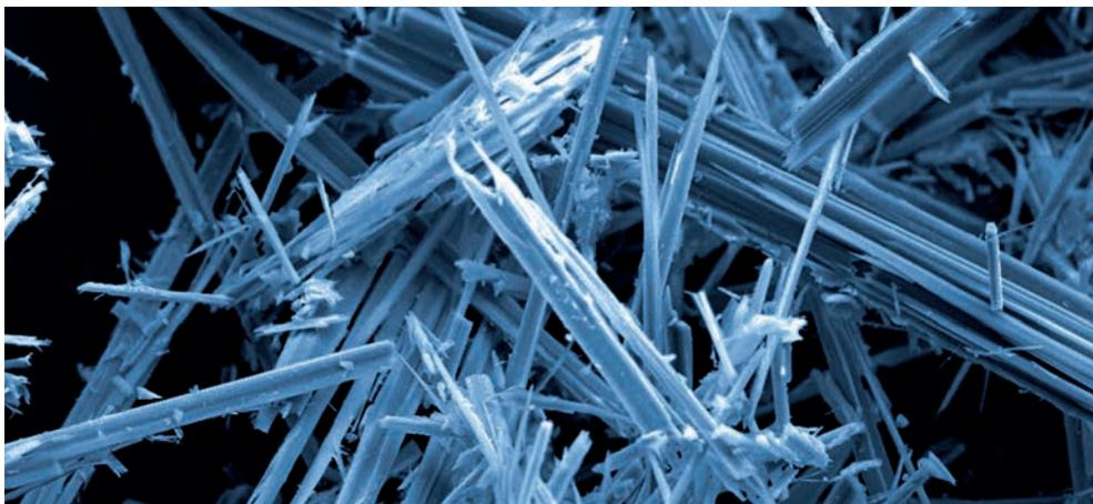
Asbestfasern unter dem Raster-Elektronenmikroskop
