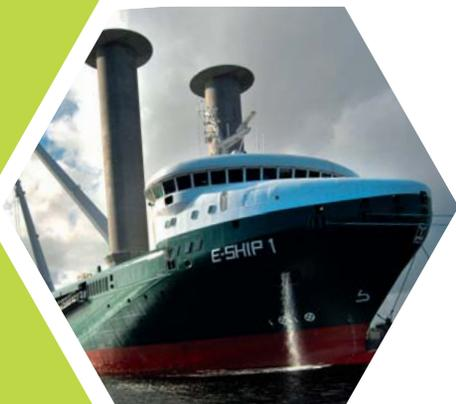
**Zu Wasser:** Mit Wind begann die Geschichte der Seeschifffahrt (oben) und mit Wind könnte sie heute weitergehen. Zumindest experimentieren Schiffsbauer mit Rotoren, die den Wind einfangen und Schiffe antreiben (unten). Für Tanker und Kreuzfahrtschiffe suchen die Hersteller nach sparsamer und umweltfreundlicher Technik.
