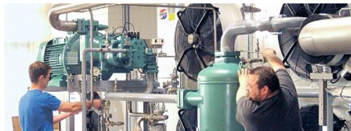
Kältetechnikfertigung bei der AKÜ, NH3(Ammoniak)-Anlage
